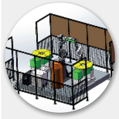
Роботизированная сварочная ячейка с двумя двухосевыми позиционерами
