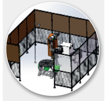
Роботизированная сварочная ячейка с двухосевым позиционером
