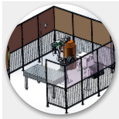
Роботизированная сварочная ячейка с стационарным сварочным столом
